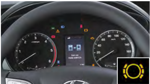
Cảnh báo má phanh mòn Chức năng an toàn này cung cấp một cảnh báo sớm để thay thế má phanh.
