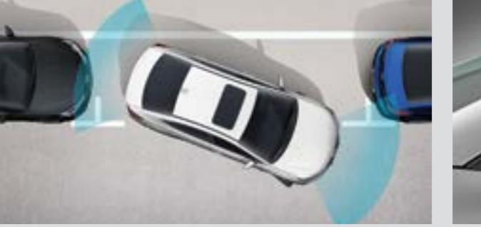
Hệ thống hỗ trợ đỗ xe với cảm biến trước sau
